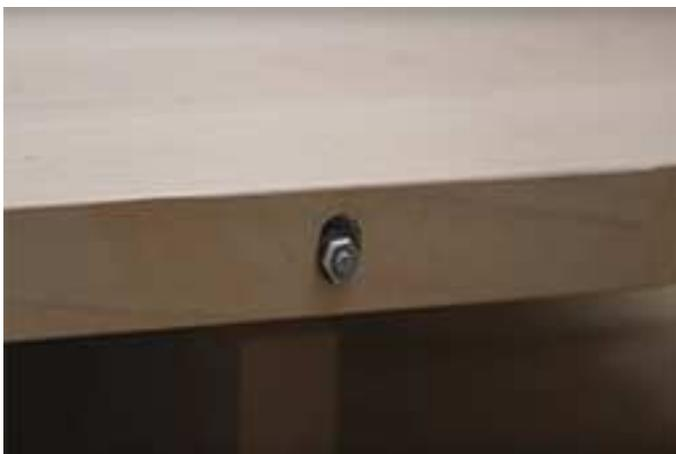
Fixez solidement les deux extrémités à l'aide d'une rondelle et d'un écrou pour chaque trou.
